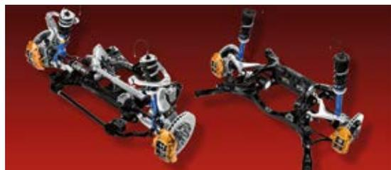
Das Handling wird über ein innovatives Allradaufhängungssystem gesteuert, das an 6 Punkten am Front- und Heck-Hilfsrahmen montiert ist. Das auf den Fahrer anpassbare Bilstein® DampTronic-Stossdämpfersystem greift auf mehrere Fahrzeuginformationssysteme zu, um optimale Dämpfung und ein hohes Mass an Kontrolle für unterschiedlichste Fahrsituationen zu gewährleisten.
