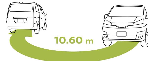
Der NISSAN EVALIA hat einen beeindruckend engen Wendekreis von 10.60 m (von Trottoirrand zu Trottoirrand). In Verbindung mit seiner Gesamtlänge von nur 4.40 m lässt er sich so einfach und sicher durch dichten Verkehr und in enge Parklücken dirigieren.
