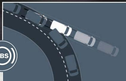
Dank ABS gerät das Fahrzeug auch bei einer Vollbremsung nicht ausser Kontrolle.
