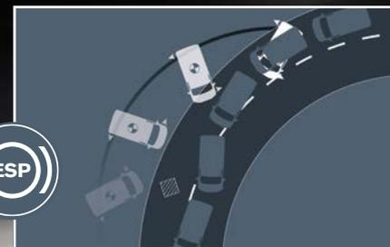
Die elektronische Stabilitätskontrolle erkennt Schleuderbewegungen automatisch und korrigiert diese eigenständig durch vorsichtiges Abbremsen einzelner Räder. Ein Ladungserkennungssystem kompensiert das Gewicht Ihrer Ladung.
