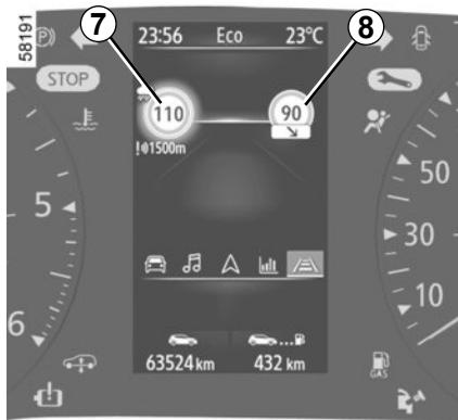
Wird die Höchstgeschwindigkeit überschritten, blinkt der Kreis (Kontrolllampe 7) und es erklingt ein Signalton, um den Fahrer zu warnen.
