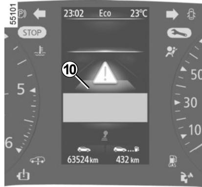
Wenn das Fahrzeug durch eine aktive Notbremsung angehalten wurde, bleibt das Fahrzeug für kurze Zeit stehen. Nach Ablauf dieser Zeit muss das Fahrzeug vom Fahrer gehalten werden, indem er den Fuß auf dem Bremspedal lässt.
