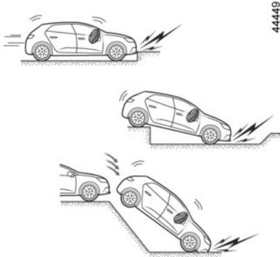
**In den folgenden Beispielen werden die Gurtstraffer und die airbags möglicherweise ausgelöst:**
