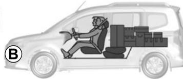
Sicherstellen, dass die zu transportierenden Gegenstände gleichmäßig im Laderaum verteilt sind.
