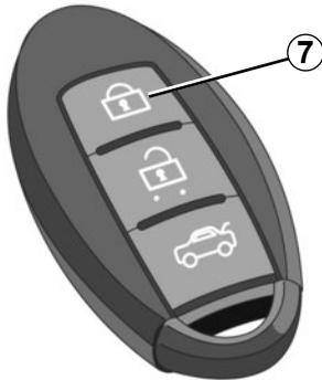
Wenn sich der Intelligent Key länger als ca. 15 Minuten innerhalb des Erkennungsbereichs **5** befunden hat, wird die Fernverriegelung deaktiviert. Um das Fahrzeug zu verriegeln, drücken Sie je nach Fahrzeugmodell die Taste **7** auf dem Intelligent Key oder die Taste **2** am **1** Griff oder drücken Sie die Taste **3** an der hinteren Flügeltür.
