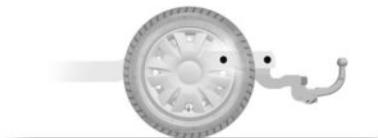
Abschleppvorrichtungen dürfen keine Beleuchtungskomponenten oder das Nummernschild verdecken, wenn sie nicht verwendet werden. Mechanische Abschleppvorrichtungen (Kugel, Haken usw.), die ohne Werkzeug entfernt werden können, sowie einziehbare Objekte müssen entfernt oder neu positioniert werden, wenn sie nicht verwendet werden.
