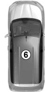
Das Fahrzeug kann nicht aus der Ferne verriegelt werden, wenn sich der Intelligent Key im Zugangsbereich **6** befindet.
