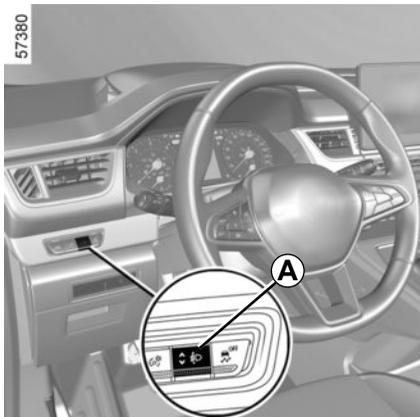
Schalter **A** wird je nach Fahrzeugbeladung zur Leuchtweitereinstellung der Scheinwerfer verwendet.
