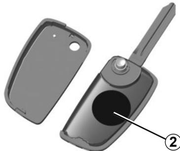
**Hinweis:** Den Elektronik-Stromkreis im Plipdeckel beim Batteriewechsel nach Möglichkeit nicht berühren.
