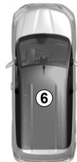
Das Fahrzeug kann nicht aus der Ferne verriegelt werden, wenn sich der Intelligent Key im Zugangsbereich **6** befindet.
