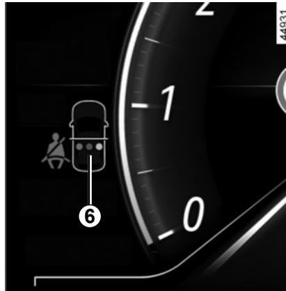
Wenn die Fahrzeuggeschwindigkeit 20 km/h erreicht oder überschreitet und einer der hinteren Sicherheitsgurte während der Fahrt geöffnet wird:
