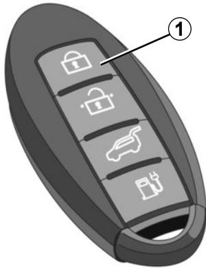
Wenn das Fahrzeug mit einer Spezialverriegelung ausgestattet ist, können alle Öffnungen verriegelt werden. Es ist dann nicht mehr möglich, die Türen mit den inneren Türgriffen zu öffnen (wenn z.B. die Scheiben eingeschlagen werden, um die Türen von innen zu öffnen).
