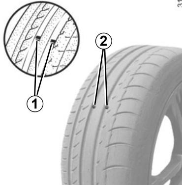
Wenn das Reifenprofil bis auf die Höhe der Verschleißanzeigen abgefahren ist, **werden diese sichtbar 2**: die Reifen müssen **jetzt** ausgewechselt werden, **da die Profiltiefe nur noch höchstens 1,6 mm beträgt und die einwandfreie Bodenhaftung auf nassen Straßen nicht mehr gewährleistet ist.**
