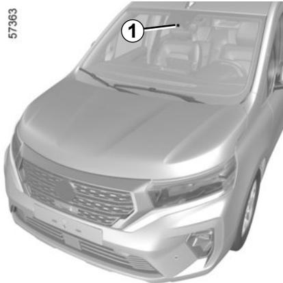
Die Funktion nutzt Informationen der Kamera **1** und löst Korrekturmaßnahmen des Lenksystems aus, wenn das Fahrzeug eine (durchgehende oder unterbrochene) Markierungslinie überfährt und dabei der Blinker nicht gesetzt ist.
