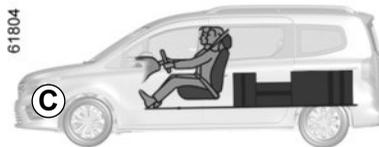
Sicherstellen, dass die zu transportierenden Gegenstände gleichmäßig im Laderaum verteilt sind.
