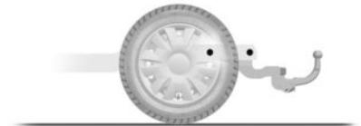
Abschleppvorrichtungen dürfen keine Beleuchtungskomponenten oder das Nummernschild verdecken, wenn sie nicht verwendet werden. Mechanische Abschleppvorrichtungen (Kugel, Haken usw.), die ohne Werkzeug entfernt werden können, sowie einziehbare Objekte müssen entfernt oder neu positioniert werden, wenn sie nicht verwendet werden.
