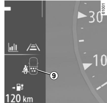
Wenn die Fahrzeuggeschwindigkeit 20 km/h überschreitet, wenn einer der hinteren Sicherheitsgurte gelöst ist oder während der Fahrt gelöst wird:
