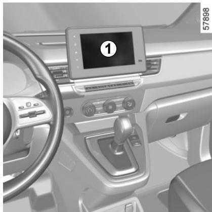
Bei laufendem Motor und stehendem Fahrzeug im Multimedia-Display **1** das Menü „Einstellungen“ wählen, dann die Registerkarte „Fahrzeug“, dann das Menü „EV-Programmierung“ **2** und dann die Registerkarte „Klimaanlage“ **4**.
