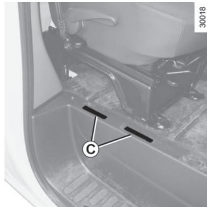
Abdeckung **C** mit einem flachen Schraubendreher oder ähnlichem Werkzeug lösen, um an die Fahrzeug-Ident-Nummer und Fahrgestell- oder Seriennummer zu gelangen.
