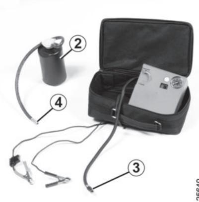
Sobald der Reifen korrekt aufgepumpt ist, das Set entfernen: Den Fülladapter **3** langsam abschrauben, um Produktspritzer zu vermeiden, und den Reifenfüllschlauch **4** auf die Behälteröffnung des Produkts zu verhindern.
