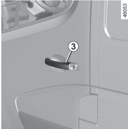
Wenn sich der Sender-Empfänger in einem der Zugangsbereiche **2** befindet, drücken Sie die Taste **3** oder **4**: alle Türen werden entriegelt.
