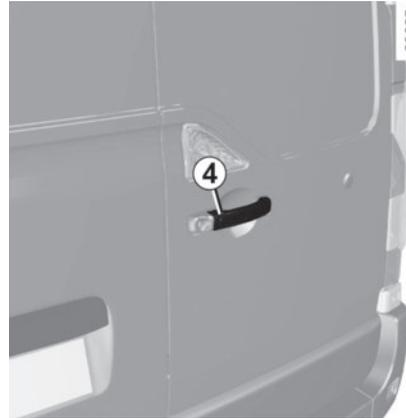
Wenn sich der Sender-Empfänger in einem der Zugangsbereiche **2** befindet, drücken Sie die Taste **3** oder **4**: alle Türen werden verriegelt.
