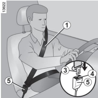
Wickeln Sie den Gurt **langsam und gleichmäßig** ab und vergewissern Sie sich, dass die Schnalle **3** in der Arretierung **5** einrastet (überprüfen Sie die Arretierung durch Ziehen an der Schnalle **3**).
