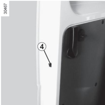
Drehen Sie bei geöffneter Tür den Hebel **4** und schließen Sie die Tür. Sie ist nun von innen verriegelt.
