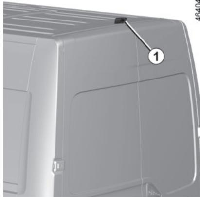
Bei eingeschalteter Zündung zeigt der Bildschirm **2** auf der Dachmittelkonsole die Sicht hinter dem Fahrzeug an, die von der Kamera **1** übertragen wird.
