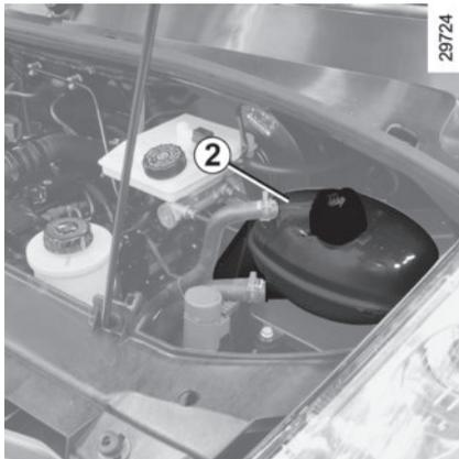
Bei stehendem Motor und waagerechtem Boden sollte der Füllstand **im kalten Zustand zwischen Wert „MINI „ und “ MAXI“** Markierungen auf dem Kühlmittelbehälter liegen 2.
