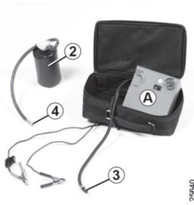
Das Endstück **3** des Kompressors am Behälter **2** befestigen, den Behälter am Kompressor **A** befestigen.
