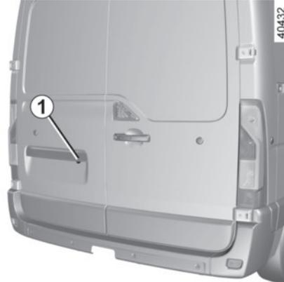
Beim Einlegen des Rückwärtsgangs überträgt die Kamera **1**, die sich an der Heckklappe oder je nach Fahrzeug an der hinteren Flügeltür befindet, einen Blick auf den Bereich hinter dem Fahrzeug auf den Rückspiegel **2** oder je nach Fahrzeug auf das Multimedia-Display **3**, begleitet von zwei beweglichen oder festen Führungslinien **4** und **5**.
