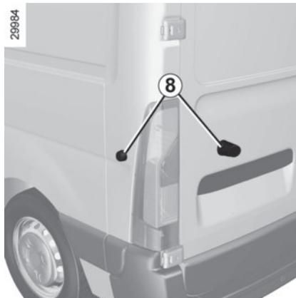
Die Strebe **7** aus dem Gehäuse ausbauen **5** wie bei der 180° Öffnung. Die Tür vollständig öffnen, bis die Magnete **8** Kontakt haben.
