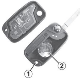
Den Kasten am Schlitz **1** mit einem Schlitzschraubendreher o.ä. öffnen und die Batterie **2** unter Beachtung des auf der Rückseite des Deckels angegebenen Typs und der Polarität austauschen.
