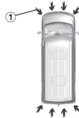
Die Ultraschalldetektoren, die durch die Pfeile **1** gekennzeichnet sind, sind im hinteren Stoßfänger (und je nach Fahrzeug im vorderen Stoßfänger) eingebaut, um den Abstand zwischen dem Fahrzeug und einem Hindernis zu messen.
