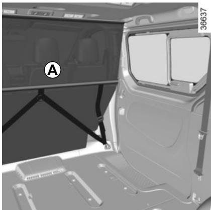
Bei Fahrzeugen mit Trennnetz **A** dient dieses beim Transport von Tieren oder von Gepäck der Trennung zwischen Gepäckraum und Fahrgastraum.
