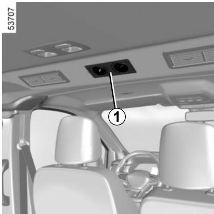
Entsprechend ausgestattete Fahrzeuge haben vier einstellbare Luftdüsen und eine Bedienkonsole **1**.
